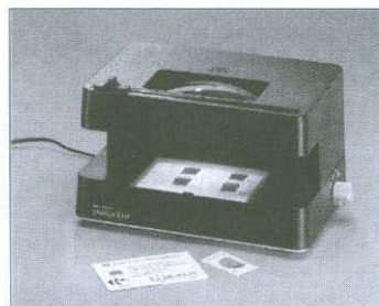
Obr. 2: Stolní sířová UV lampa Philalux, umožňující prohlídku v UV záření obou vlnových délek (254 a 366 nm) a dále prosvícení známky zesponu a její zvětšení dvěma lupami v horní části lampy.
