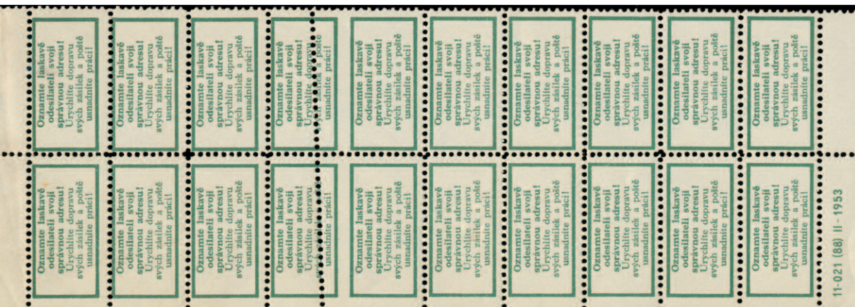
I na těchto nálepkách lze doložit výrobní vady, v tomto případě šikmo posunutě zoubkování v páté vodorovné řadě.
